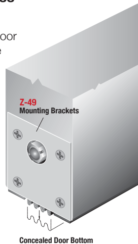
Concealed Door Bottom
