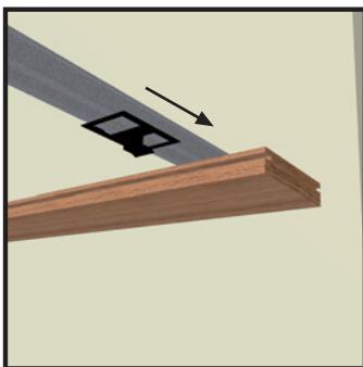
**5** Una vez fijado el primer panel, procedemos a instalar el siguiente, introduciendo una de las hembras en la pieza de fijación doble hembra que sustenta el otro panel, tal y como se aprecia en la imagen.
