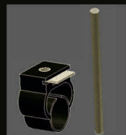
Replantear y trazar los taladros del diámetro adecuado al taco expansivo a utilizar para varilla de métrica 6 mm. La distancia entre los mismos será la que hayamos elegido previamente de acuerdo a las condiciones recogidas en los puntos 1 y 2. Los puntos en los que se efectúen los taladros deberán ser lo suficientemente compactos y resistentes para aguantar la carga calculada.
