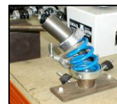
Ensayo de pandeo para medir la resistencia de los casquillos fijados al muelle
