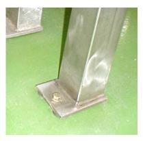
Cuando se precisa fijar los apoyos para evitar desplazamientos laterales en maquinaria, con MULTIPAD podemos también realizarlo sin temor a provocar puntos de transmisión vibratoria.
