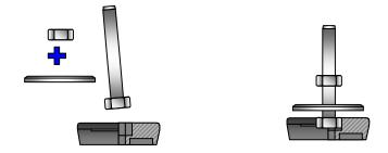
MULTIPAD también se utiliza como apoyo elástico para desacoplar grandes estructuras metálicas de los apoyos en un forjado.
