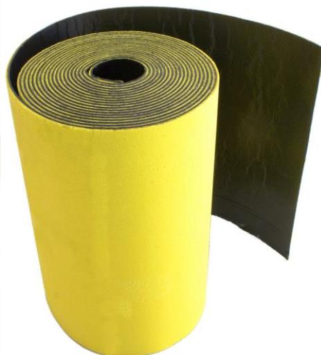
**Fonodan BJ**, es una membrana aislante acústica especial para descargas sanitarias. Está compuesto por dos tipos de materiales, una membrana autoadhesiva de alta densidad y un polietileno químicamente reticulado, termo soldados entre sí.
