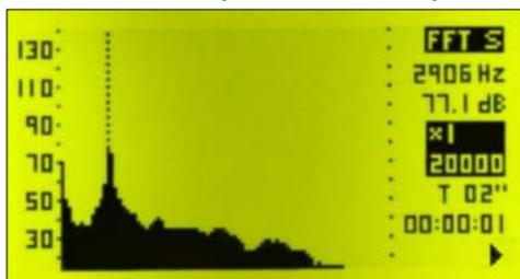
Este módulo de análisis frecuencial extendido del sonómetro **SC310** incorpora 2 modos de medición: modo análisis frecuencial extendido en 1/3 de octava y modo análisis frecuencial de banda estrecha FFT (Fast Fourier Transform).
