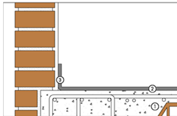
Figura 12: Encuentro con el cerramiento de fachada o con la medianería mixta mediante solape vertical. 1) Concreto. 2) IMPACTODAN®; 3) Solape vertical suficiente
