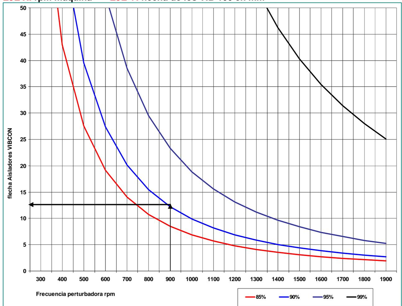
**EJEMPLO:** Planta enfriadora aire-agua: ventiladores a 900 rpm y compresores a 1500 rpm.
