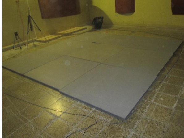
Figura 2 – Vista del montaje del manto del material fonoabsorbente sobre el piso de la cámara.
