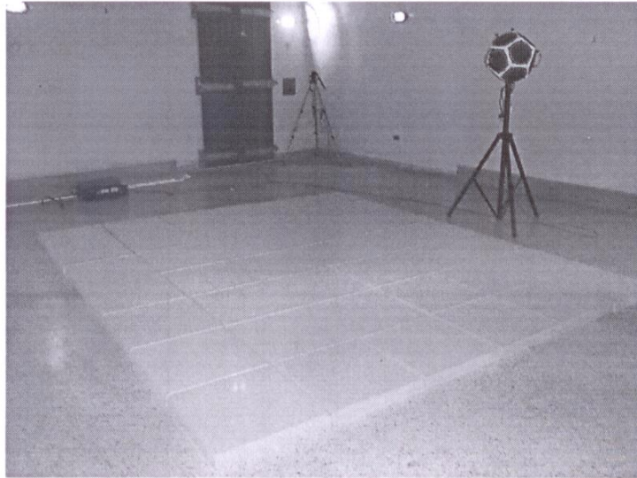
Fotografía 1: Montaje de ensayo en cámara reverberante
