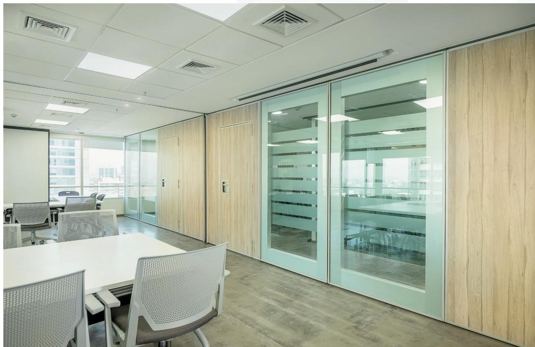
Sistema modular para dividir física y acústicamente grandes superficies, permitiendo el uso parcial de los recintos con total privacidad. Posee un sistema de riel suspendido y no requiere ningún tipo de guía en el piso. Permite almacenarlos a distancia de manera simple.
