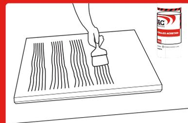
Aplicar adhesivo Fonac en la cara posterior de la placa y colocaras antes de que seque.
