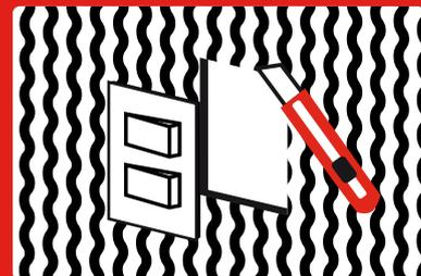
Con un corta cartón, se pueden hacer cortes para interruptores, teclas de luz, etc; antes que la placa fonoabsorbente esté colocada.
